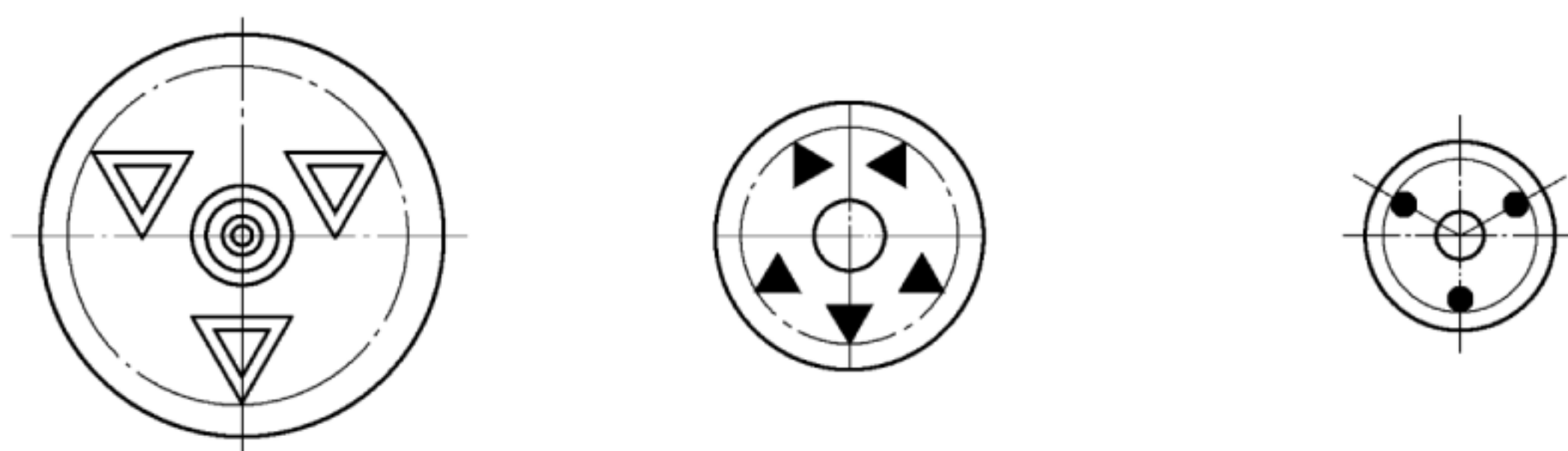
图 4 管和盒上触摸危险标识放置示例
